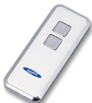
Handzender Mini-Novotron 522 Design Tweekanaals, 433 MHz, KeeLoq-Wisselcode
